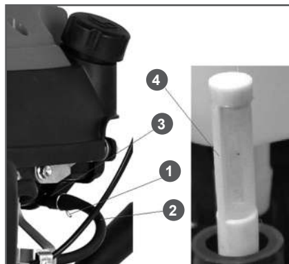
Рис.20 Чистка фильтра топливного бака
