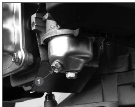
Рис. 19 Слив топлива из карбюратора 1. Болт сливной
