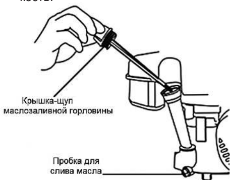
Рис. 15 Замена моторного масла
