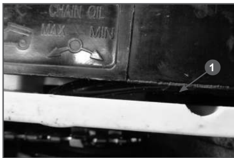
Рис. 8 Винт регулировки подачи масла
