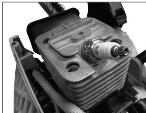
Рис. 28 Охлаждающие ребра цилиндра
