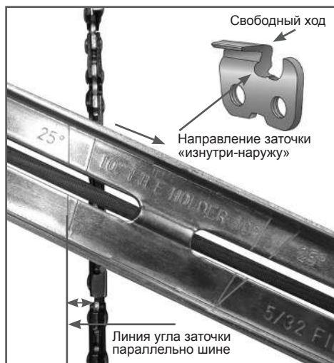
Рис. 22 Расположение линии угла заточки
