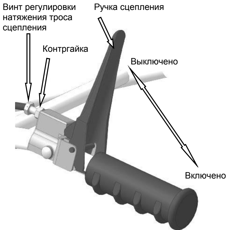
Рис.13. Схема работы ручки сцепления.
