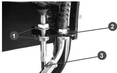
Рис. 11 Крепление оболочки троса включения хода
