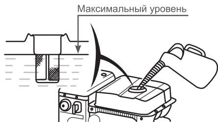
Рис. 31 Максимальный уровень топлива в топливном баке
