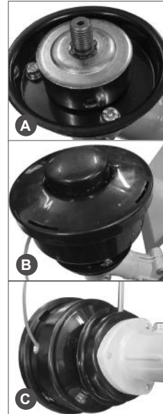
Рис. 6 Установка триммерной головки
