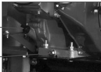
Рис. 10 Проверка уровня масла в картере
