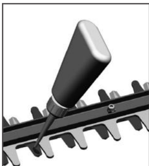
Рис. 3 Смазка режущих ножей
