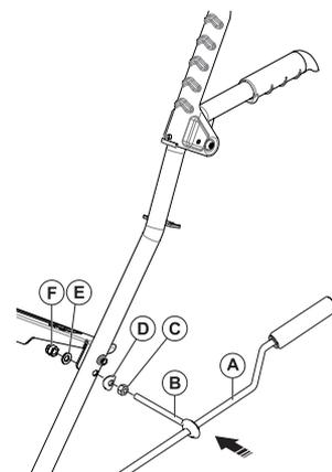
Присоедините рукоятку (А) поворотного желоба к левой ручке, при помощи крепёжных элементов - бокс № 5: (С) гайка с шайбой M8 – 1 шт.; (D) фигурная шайба D8 – 1 шт.; (E) шайба D8 – 1 шт.; (F) гайка M8 – 1 шт.
