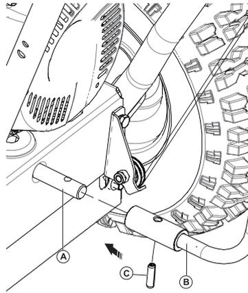
Проденьте через панель и установите рукоятку (B) переключения передач на вал (A), зафиксируйте ее шплинтом (C) из набора крепежных элементов бокс №2.
