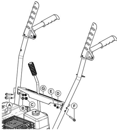
Установите панель переключения передач (G) закрепив ее крепежными элементами из бокса №3: (A) болт 6x40 – 2 шт.; (B) шайба D6 – 2 шт.; (C) гайка M6 – 2 шт.; (D) шайба D8 – 1 шт.; (E) гайка M8 – 1 шт.; (F) болт 8 – 1 шт.
