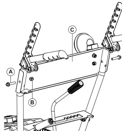
Прикрепите панель управления (C) к рукояткам используйте элементы крепежа из бокса №6: (A) болт 8x40 – 2 шт.; (B) гайка M8 – 2 шт.
