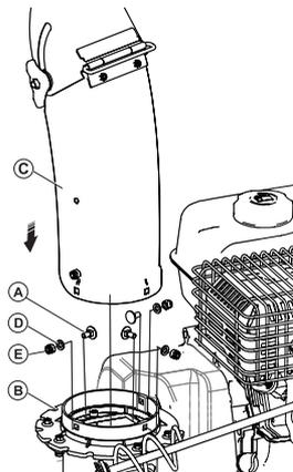
Установите поворотный желоб (С) на площадку снегоуборщика (В). Используйте крепёжные элементы - бокс №: 7 (А) болт 6x15 – 3шт.; (D) шайба D6 – 3 шт.; (E) гайка M6 – 6 шт. и закрепите.
