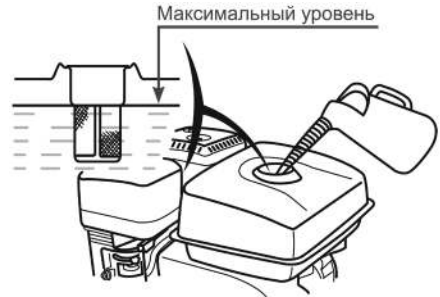
Рис. 5 Максимальный уровень топлива в топливном баке
