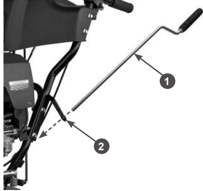
Рис. 23 Установка рычага управления поворотом жёлоба
