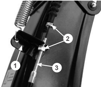
Рис. 21 Установка оболочки троса управления дефлектором жёлоба
