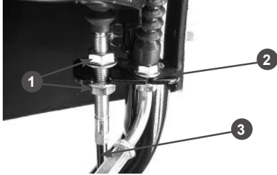
Рис. 10 Крепление оболочки троса включения хода
