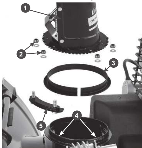
Рис. 18 Установка жёлоба выброса снега
