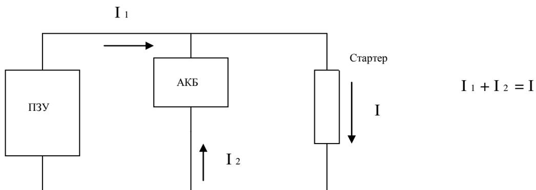
Ток, потребляемый стартером равен сумме токов от аккумулятора и пускового устройства. Чем меньше ток дает аккумулятор (разряжен), тем больше будет потребляться ток с пускового устройства и наоборот.
