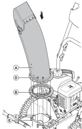
Установите поворотный желоб (A) со специальным кольцом (B) на площадку снегоуборщика. Используйте крепёжные элементы - бокс №4: (D) болт M6x20 – бшт.; (C) скоба – 3 шт.; (E) гайка M6 – 6 шт. и закрепите.
