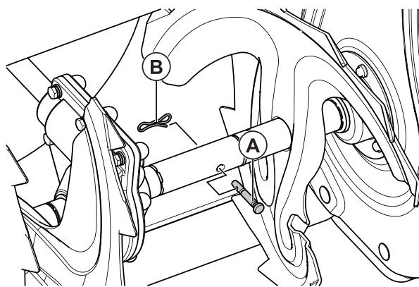
Шнеки крепятся к валу с помощью предохранительных (резьбовых) штифтов. В случае столкновения шнека с посторонним предметом или ледяным затором, штифты срезаются и шнек перестает вращаться, предотвращая повреждения других частей снегоуборщика.
