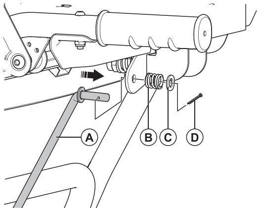
Установите на верхней рукоятке в приемное отверстие рычага переключения передач тягу (A), используйте крепёжные - бокс №7: (B) пружина - 1 шт.; (C) стопорное кольцо - 1 шт.; (D) шплинт - 1 шт.
