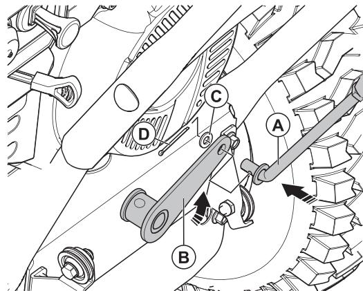
Установите на снегоуборочной машине в отверстие коннектора (B) тягу (A) и закрепите, используйте крепежные элементы - №8: (C) шайба - 1 шт.; (D) шплинт - 1 шт.
