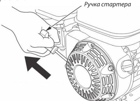
**Примечание!** Не рекомендуется вытягивать шнур стартера максимально (на всю длину), а также резко не отпускайте его при повторной попытке завести двигатель, удерживая рукоятку, плавно верните его в исходное положение.
