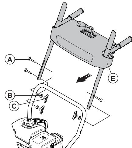
Совместите отверстия нижней и верхней рукояток, и закрепите при помощи болтов и пластиковых барашковых гаек. Используйте крепёжные элементы - бокс №3: (A) болт M8x50 – 3шт.; (B) фигурная шайба – 3 шт.; (C) барашковая гайка M8 – 3 шт. Затяните болты от руки.
