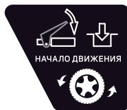
Нажмите на рычаг привода хода по направлению к ручке управления, снегоуборщик начнет движение. Для отключения привода движения отпустите рычаг.
