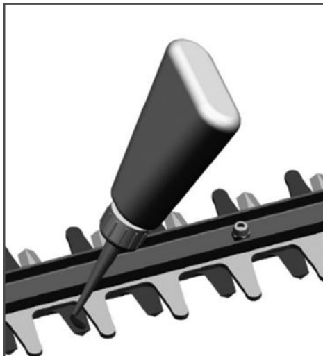
Рис. 5 Смазка режущих ножей
