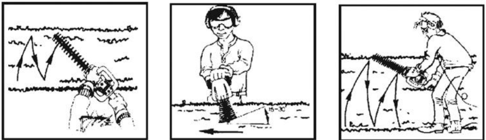
Рис. 4 Движения ножницами при обрезке
