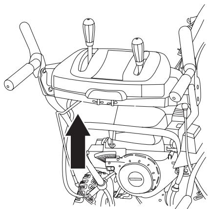
Установите на верхней рукоятке в приемное отверстие рычага переключения передач тягу (А).
