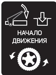
Нажмите на рычаг привода хода по направлению к ручке управления, снегоуборщик начнет движение. Для отключения привода движения отпустите рычаг.
