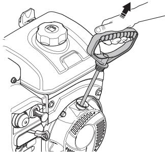
**Примечание!** Не рекомендуется вытягивать шнур стартера максимально (на всю длину), а также резко отпускать его при повторной попытке завести двигатель. Удерживая рукоятку, плавно верните его в исходное положение.
