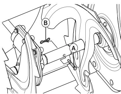
Шнеки крепятся к валу с помощью предохранительных (резьбовых) штифтов (болтов). В случае столкновения шнека с посторонним предметом штифты срезаются и шнек перестает вращаться.
