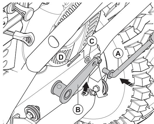
Установите на снегоуборочной машине в отверстие коннектора (В) тягу (А) и закрепите.
