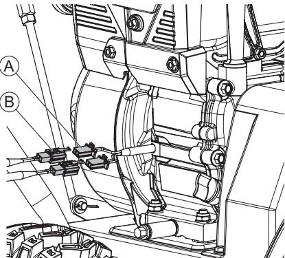
Для комфортного использования снегоуборочной машины она снабжена фонарем освещения и подогревом рукояток. Произведите подключение разъемов электрического кабеля. Закрепите проводку на нижней рукоятке пластиковыми клипсами.
