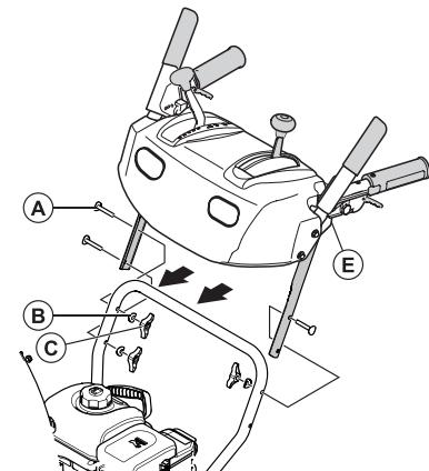
Совместите крепежные отверстия на нижней рукоятке (D) и корпусе снегоуборщика. Затяните с моментом затяжки 25 Нм.
