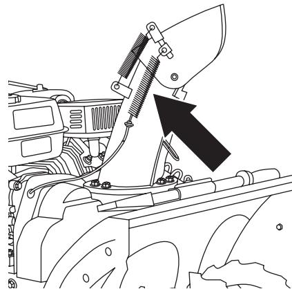
Подключите трос регулировки наклона дефлектора.
