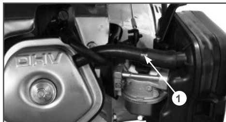
Рис. 15 Трубка системы вентиляции картера
