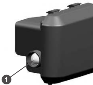
Рис. 13. Расположение ручного топливного насоса
