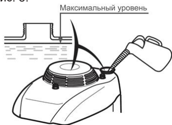
Рис. 8 Максимальный уровень топлива в топливном баке
