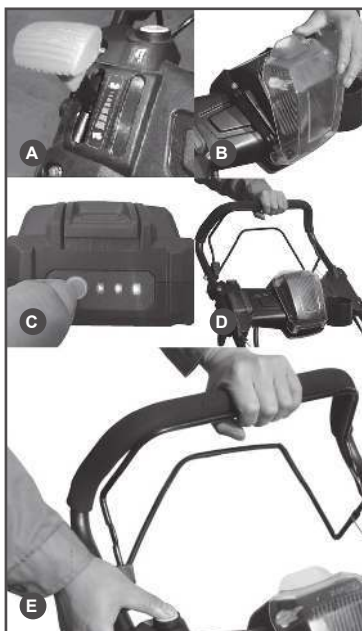
Рис. 9 Запуск двигателя электрическим стартером
