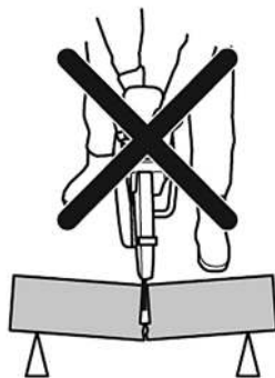
Рис. 15 Отдача при защемлении диска
