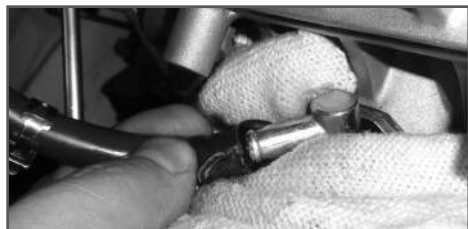
Рис. 10 Удаление воздуха из топливного шланга
