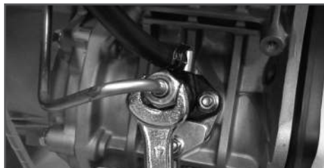
Рис. 12 Удаление воздуха из топливного насоса
