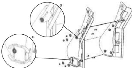
\* Рекомендована установка дополнительной шайбы между деталью и кожухом шнека (идет в комплекте).
