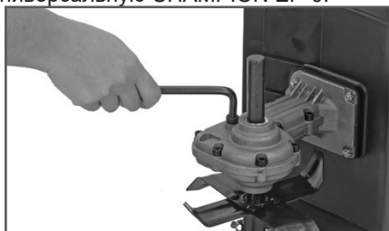
Рис. 7 Проверка смазки в редукторе
