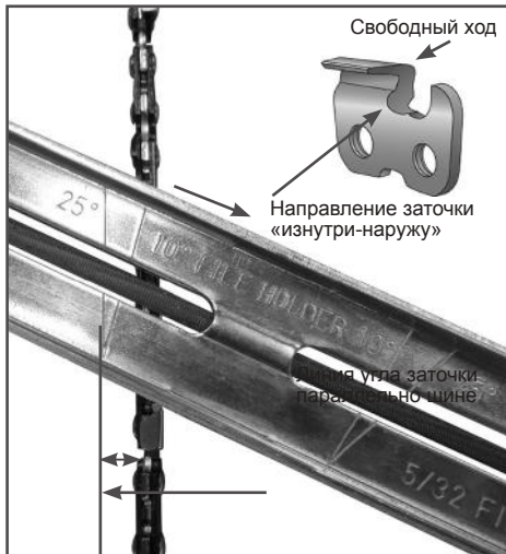
Рис. 22 Расположение линии угла заточки
