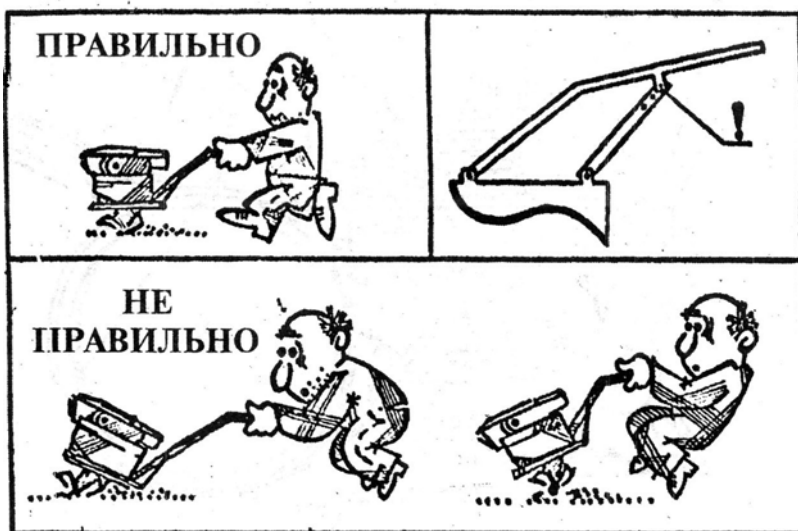
Рис. 10. Регулировка высоты руля.
