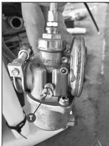
Рис. 16 Расположение винтов регулировки карбюратора
