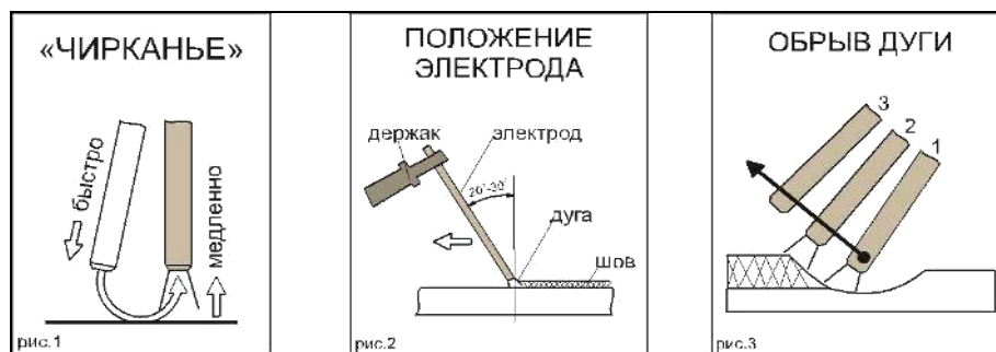
Рис. 6. Действия с электродом
