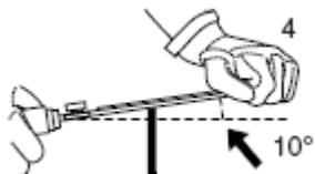
Держите напильник под углом 10° вверх. Напильник регулярно переворачивайте во избежание одностороннего износа. Заточите сначала самые поврежденные режущие зубы, а затем остальные, подгоняя их по той же самой длине.
