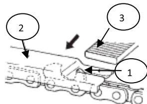
Контролируйте высоту ограничителя глубины резания с помощью специального шаблона(2). Выступающую часть ограничителя глубины резания (1) сточите с помощью плоского напильника (3).
