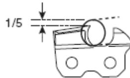
При заточке цепи напильник должен выступать над верхней гранью на 1/5 часть своего диаметра (20%). Проще всего выдержать этот размер, если вы будете применять при заточке цепи специальную державку для напильника. После 3-4 заточек цепи обязательно проверяйте высоту ограничителя глубины резания. Опилки от заточки удаляйте куском твердого дерева.
