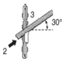
Диаметр напильника должен соответствовать шагу цепи. Заточку следует производить только при движении напильника изнутри наружу. Напильник снимает металл только при движении вперед. Строго выдерживайте величину режущего угла. При движении назад напильник необходимо приподнимать. Не опиливайте соединительные и ведущие звенья.
