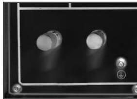
Рис.12 Клеммы DG10000E
