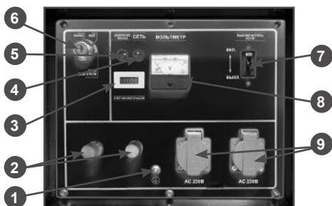
**Рис. 3 Панель управления DG10000E**
