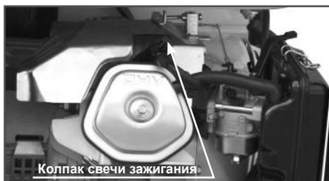
Рис. 14 Место расположения свечи зажигания
