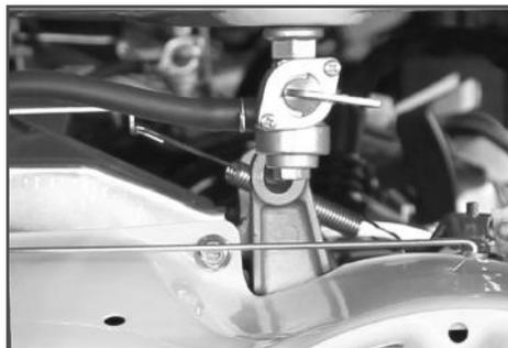
Рис.13 Обслуживание фильтра-отстойника
