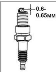
Рис. 13 Определение зазора свечи
