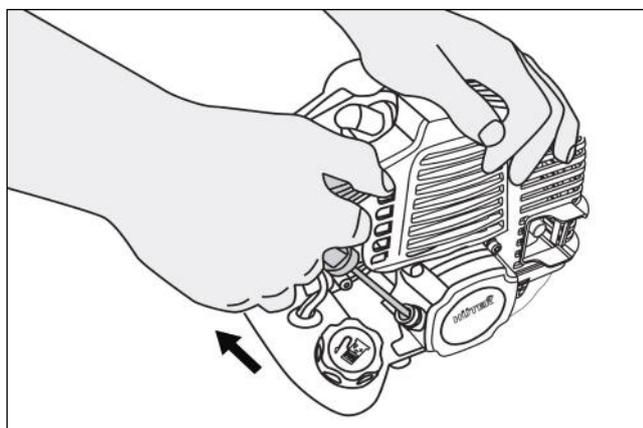
Рис. 9 Запуск двигателя
