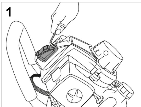
Рис. 14. Откручивание винта и снятие пластиковой крышки
