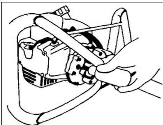
Рис. 16 Смазка передач
