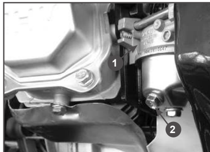
Рис. 18 Слив топлива из карбюратора
