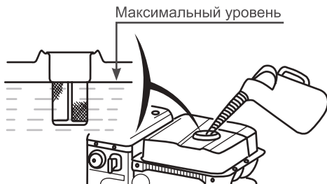
Рис. 11 Максимальный уровень топлива в топливном баке
