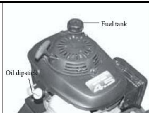
2. Топливный и масляный бак (двигатель Honda)
