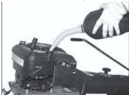
1. Топливный и масляный бак (двигатель V&S)
