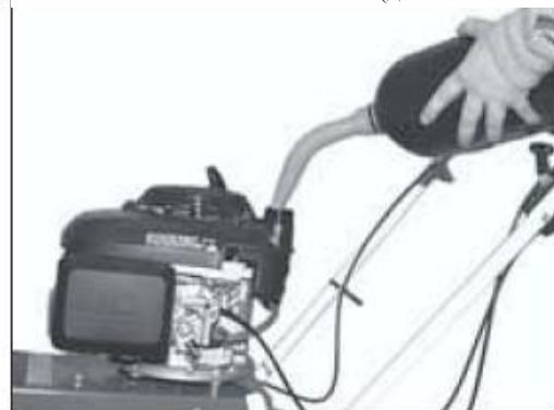
1. Топливный и масляный бак (двигатель Honda)
