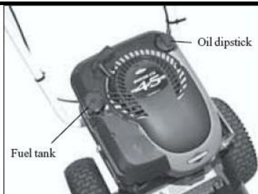
1. Топливный и масляный бак (двигатель V&S)
