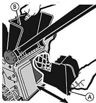
Рис. 19 Установка заглушки для мульчирования
