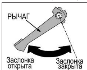
Рис. 14 Рычаг управления воздушной заслонкой PC5332F (вид сверху)
