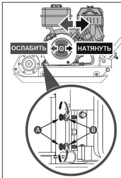
Рис. 31 Регулировка натяжения ремней РС6337F
