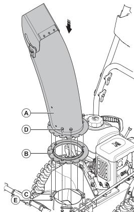
Установите поворотный желоб (A) со специальным кольцом (B) на площадку снегоуборщика. Используйте крепёжные элементы - бокс №4: (D) болт M6x20 – 6шт.; (C) скоба – 3 шт.; (E) гайка M6 - 6 шт. и закрепите.
