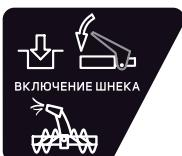
Нажмите на рычаг привода шнека по направлению к ручке управления, шнек начнет вращение и можно начинать расчистку снега. Для отключения шнека отпустите рычаг.
