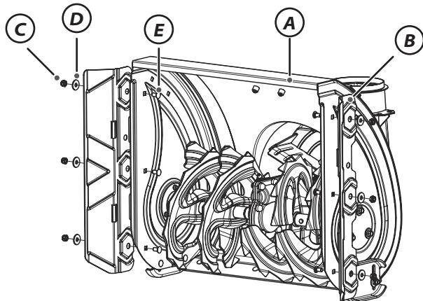
Система Original Extension System (XTS) позволяет увеличить ширину или высоту ковша, повысить производительность и возможность использования при очистке высоких сугробов.
