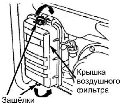
Рис. 14 Снятие крышки воздушного фильтра
