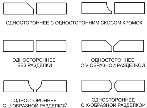
Рис. 14. Виды стыковых соединений
