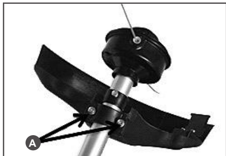
Рис. 2 Установка защитного кожуха
