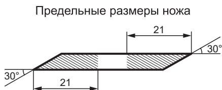
Рис. 32 Размеры ножа
