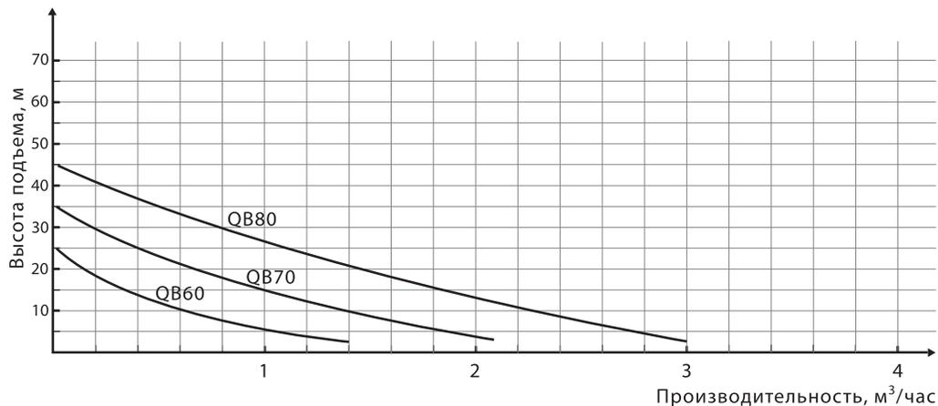
при снижении напряжения питания на 10 % высота подъема снижается на 60 %;
