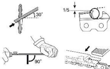
После выравнивания по шаблону ограничителя глубины реза, округлите переднюю кромку, чтобы уменьшить вибрацию цепи при пилении.
