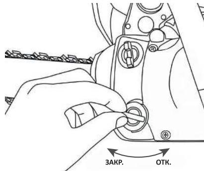
**ВНИМАНИЕ!** Всегда наполняйте бак для смазки цепи при заправке топливной смесью.
