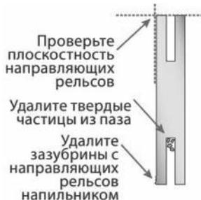
Для равномерного износа шины и продления срока ее эксплуатации переворачивайте шину каждые 8 часов работы. Это позволит равномерно распределять износ полотна. Держите паз шины и отверстие для смазки в чистоте.
