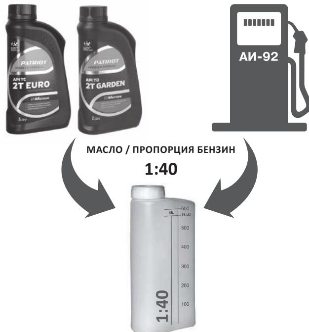
Открутите крышку топливного бака и заполните топливный бак. Если вручную открутить крышку топливного или масляного бака тяжело, вставьте прилагаемый торцовый ключ в паз на крышке и поверните его против часовой стрелки.
