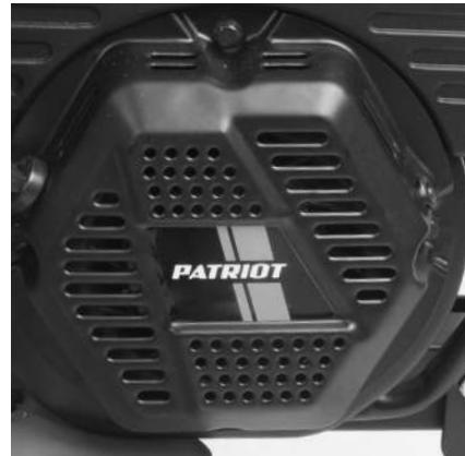
При загрязнении охлаждающих отверстий стартера продуктами культивации почвы, пылью, масляным шламом используйте для очистки кисточку и/или баллон со сжатым воздухом.
