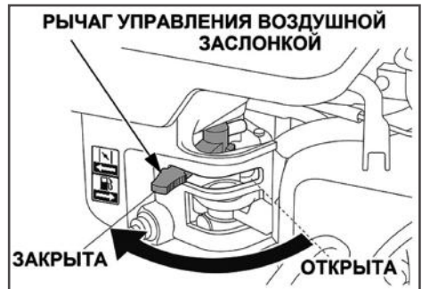
Рис. 11 Воздушная заслонка закрыта
