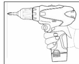
Установите регулировочное кольцо на соответствующий уровень крутящего момента для Вашей работы. Вставьте острие отверточной биты в головку винта и надавите на инструмент. Включите инструмент на медленной скорости, затем постепенно увеличивайте ее. Отпустите триггерный переключатель, как только сработает сцепление.
