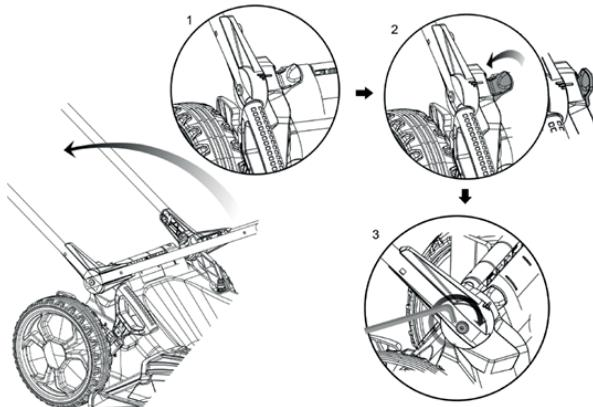
Выберите удобную установку высоты рукоятки и зафиксируйте нижние быстросажимные фиксаторы.
