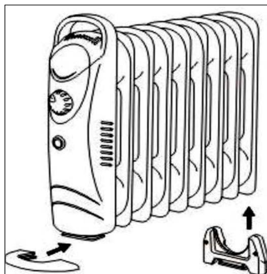
Рис. 4. Установка опор
