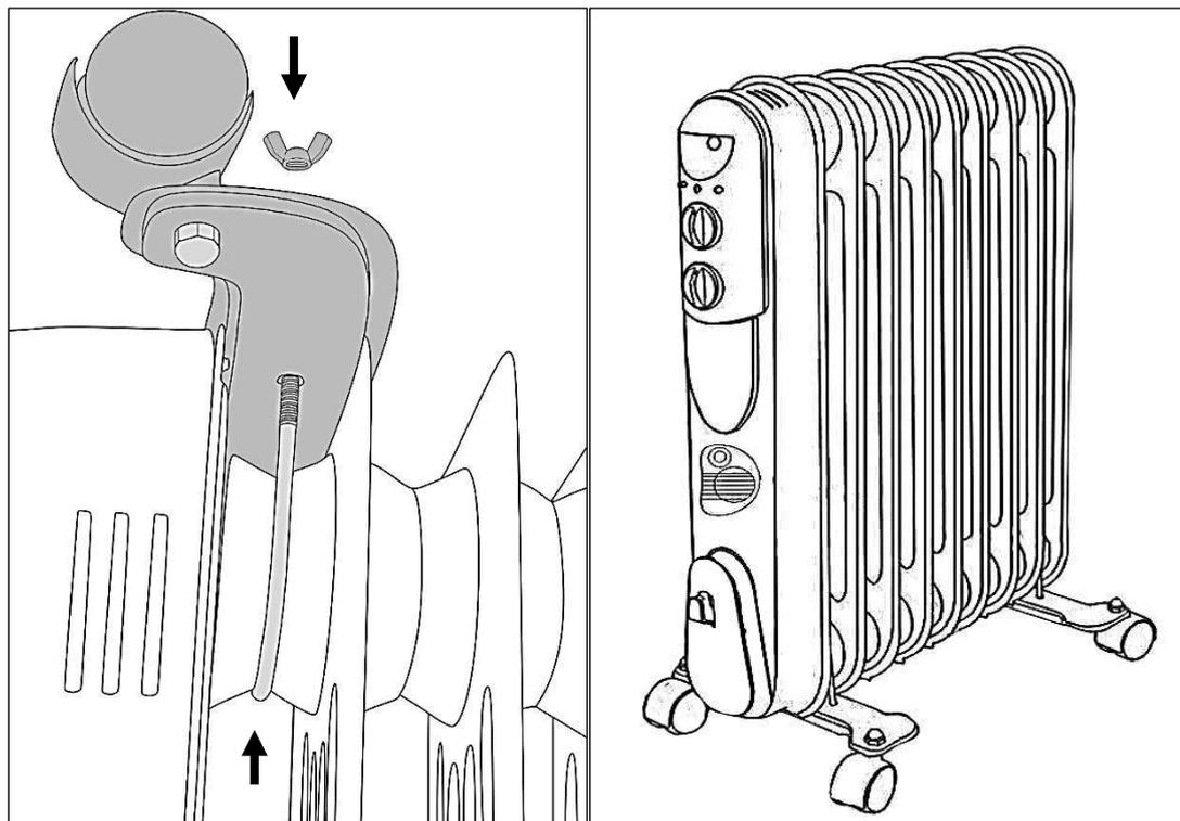
Рис.3. Установка колёс
