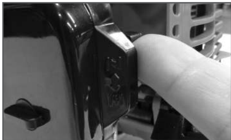
Рис.9 Закрытие воздушной заслонки
