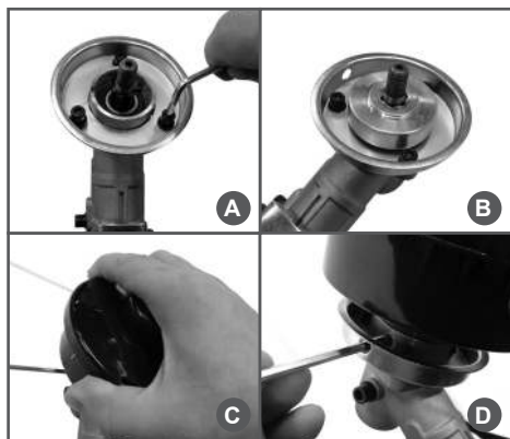
Рис.6 Установка триммерной головки
