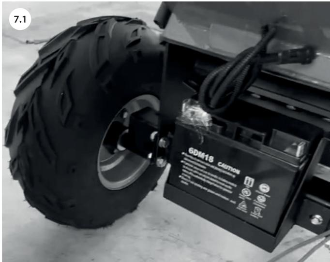
8. Подключите клеммы проводов питания к аккумулятору. Кабель красного цвета крепится к клемме «+».
